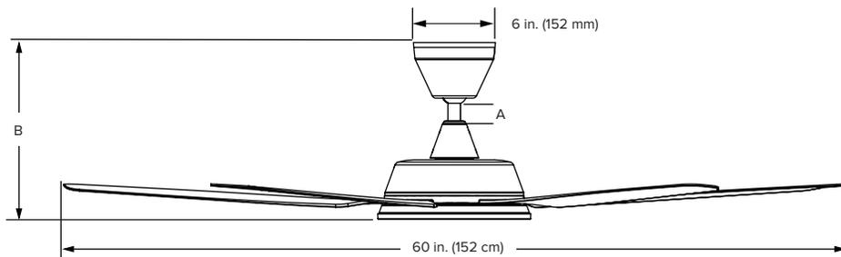
Ilustrado con un tubo de montaje de 5 in. (128.5 mm)<sup>1</sup>
