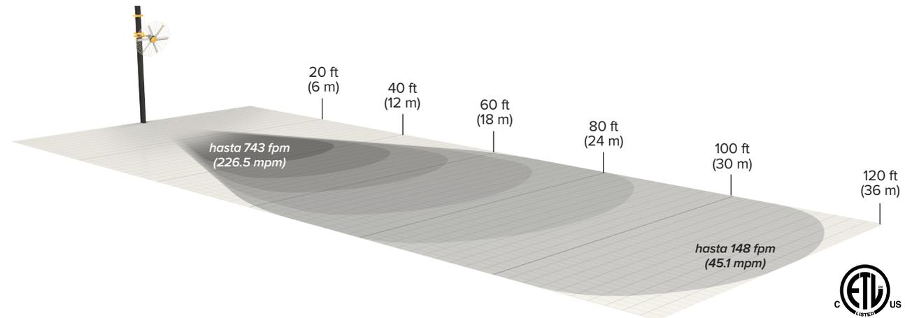
Pivot de montaje en columna sometido a una prueba a 10 ft (3 m) sobre el suelo y con cuatro sensores a diferentes alturas.
